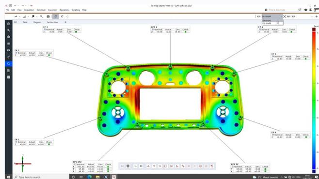
Une capture d'écran du logiciel GOM Inspect, qui permet à la fois de faire fonctionner le scanner et d'offrir des fonctionnalités d'inspection. Source : Aniwaa/GOM ([test GOM Scan 1](#))
