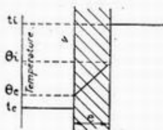
Propagation de la chaleur par conduction et convection à travers une paroi
