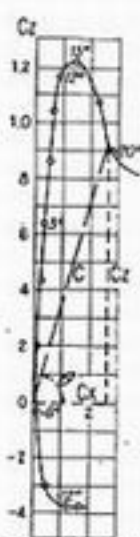
Fig 2. Polaire d'une aile à échelles égales
