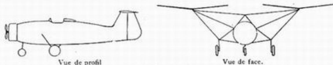
Fig. 10.411.1. Hélicoptère Focke-Wulf 111. (à l'avant, un moulinet pour le refroidissement du moteur, qui ne joue en aucune façon le rôle d'hélice tractive comme dans l'autogire).
