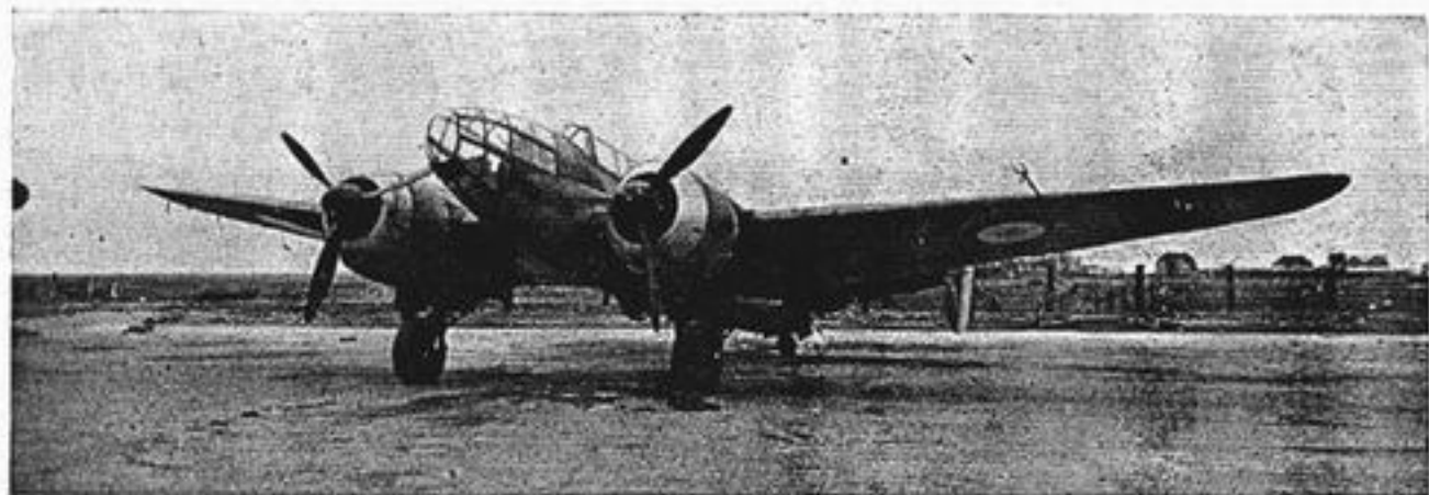
4. — TRIPLACE DE RECONNAISSANCE ET BOMBARDEMENT BLOCH 175 2 moteurs Gnome-Rhône 14 N 48-49
