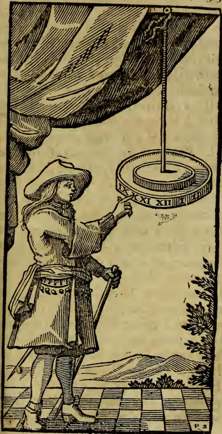
en sécheresse le jour précédent , & on conjecture par là si le tems sera beau ou pluvieux. Pour empêcher que l'air n'agite cet *hygromètre*, & ne le rende inutile, on le couvre d'une espèce de cloche de verre, au haut de laquelle il y a un trou pour laisser un passage libre à la corde, afin qu'elle se puisse mouvoir sans nul empêchement.
