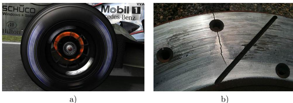
FIGURE 2 – a) Dissipation thermique due au frottement dans un disque de formule 1 b) Disque de frein usé par frottement.
